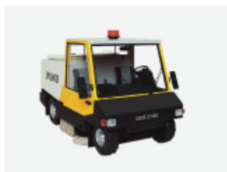
Zamiatarka uliczna dwuosobowa
